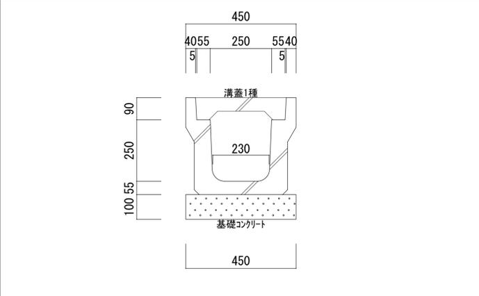
側溝取合柵 平面断面詳細図 S=1:10
